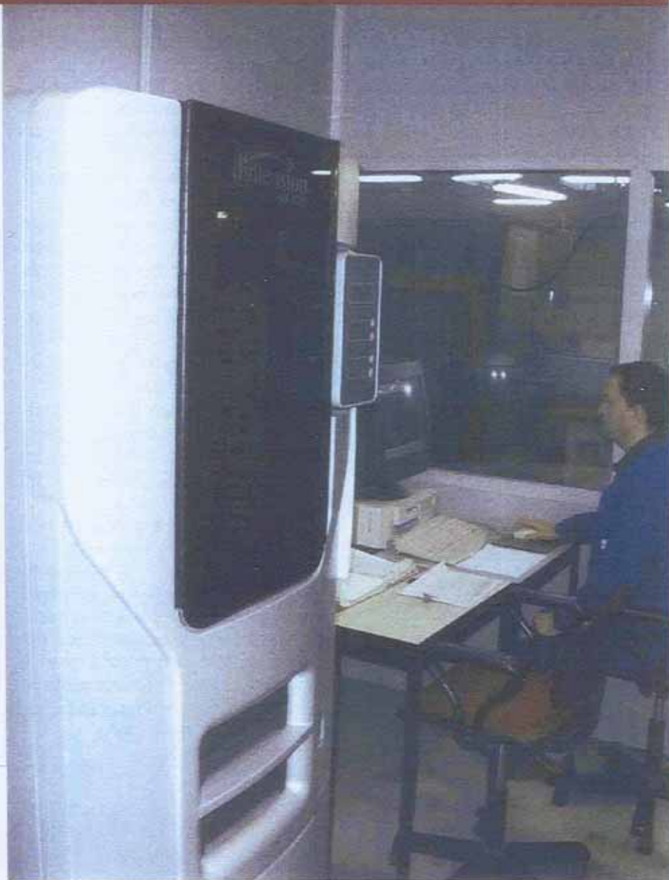
La stampante tridimensionale Dimension SST 1200 nell'Officina Modelli di Electrolux Home Products di Forlì.
